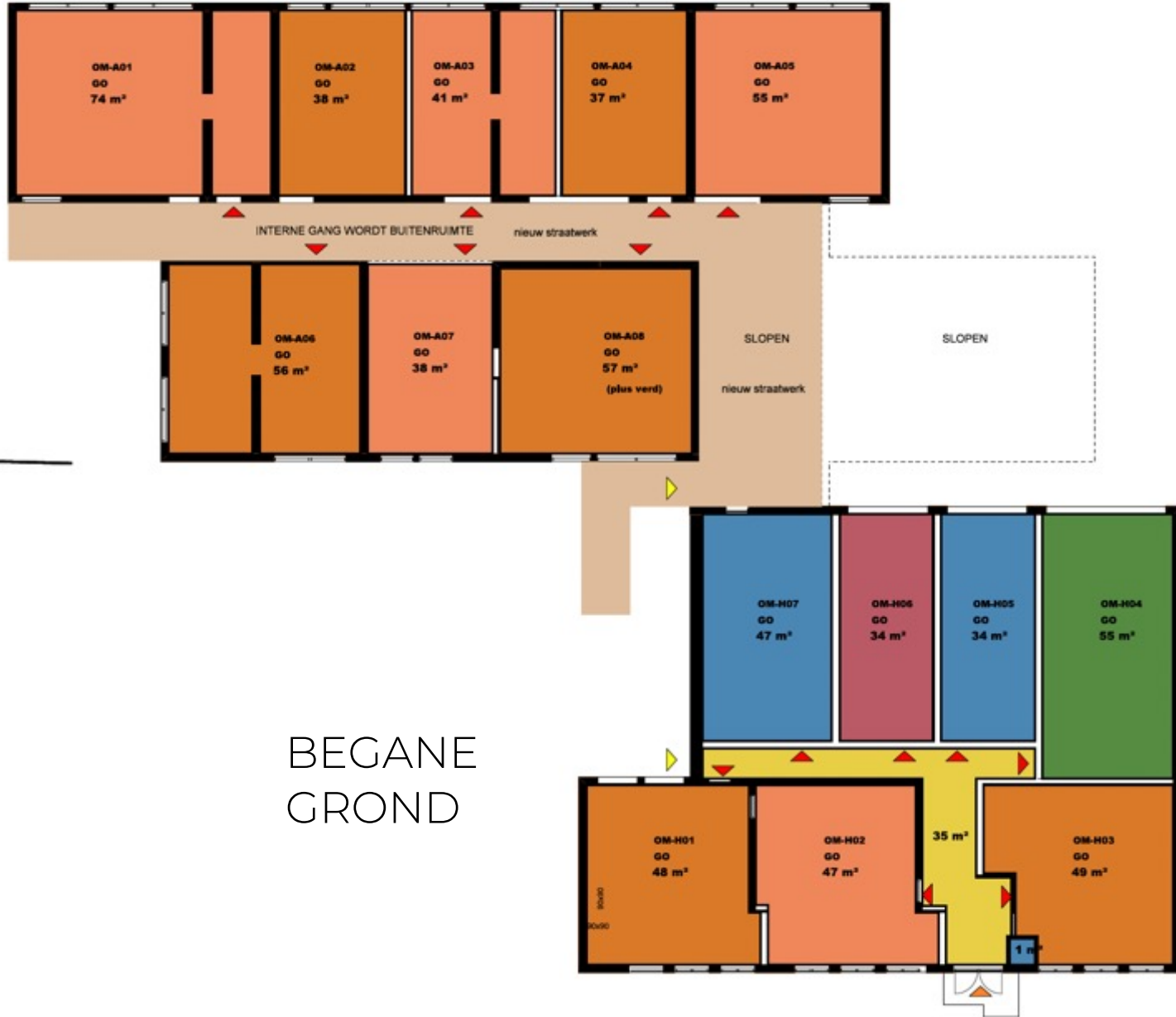
INTERNE GANG WORDT BUITENRUIMTE
